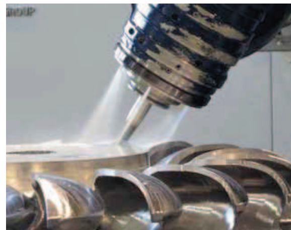
I particolari realizzati richiedono spesso complesse lavorazioni a 5 assi
